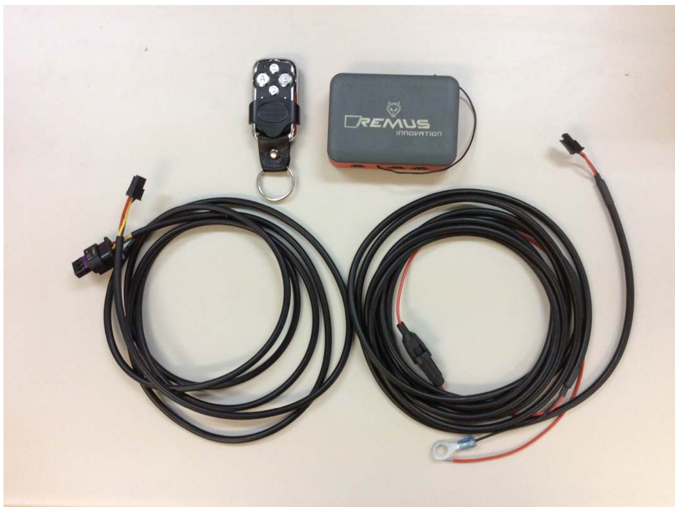
バルブ操作用リモコンとリモコン受信ユニット (マフラーに付属します)
