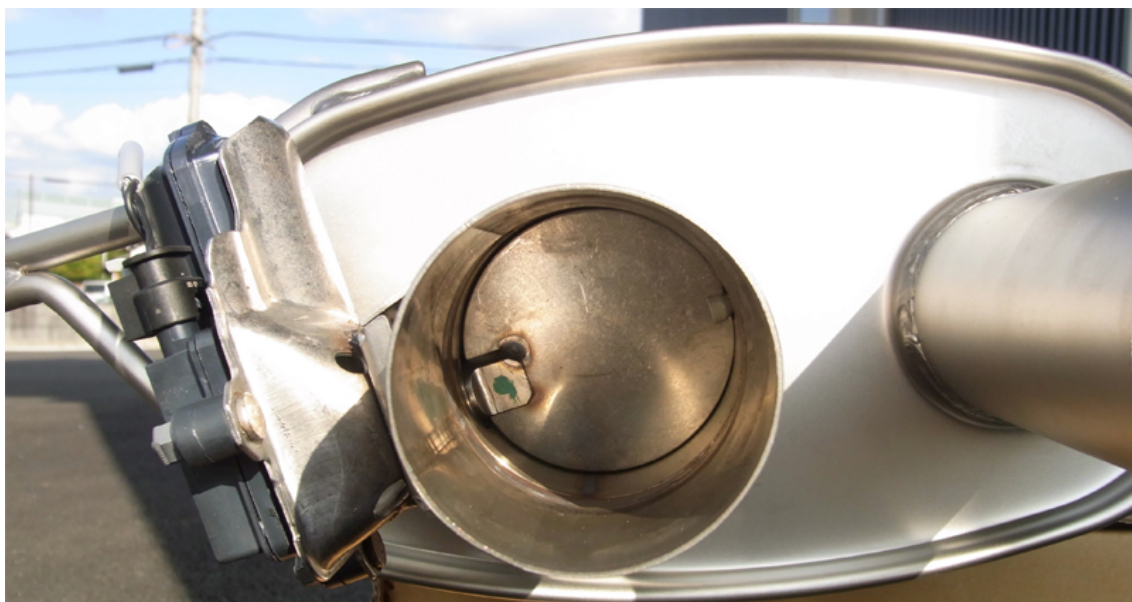
バルブ閉の状態（バルブが付属するのは左側出口のみです）
