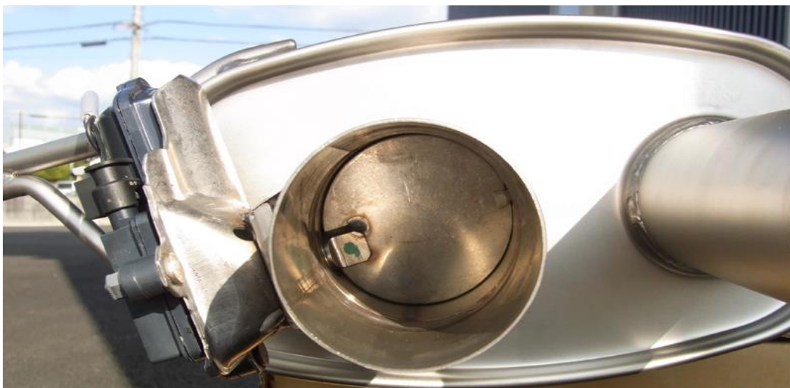
バルブ閉の状態(バルブが付属するのは左側出口のみです)
